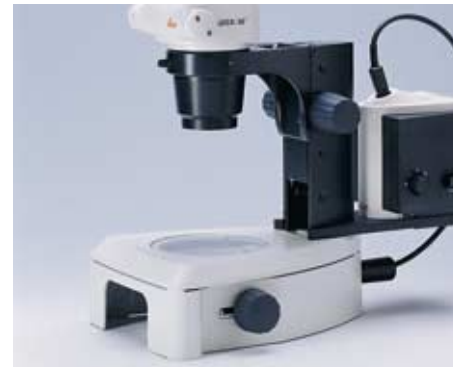
Durchlichtuntersatz und Universallichtleiter für schiefe Durchlichtbeleuchtung
